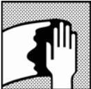
Eliminar qualquer contaminação da superfície antes de lixar utilizando o limpador /desengordurante adequado.
