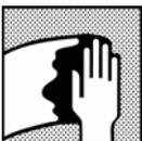
Limpeza da superfície, eliminar qualquer contaminação da superfície antes da aplicação do primário – aparelho utilizando o limpador/desengordurante adequado.
