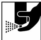
Depois da sua aplicação, inverter o aerosol e manter apertado 2 – 3 segundos. Isto permite limpar suficientemente a boca para a sua posterior utilização.
