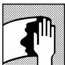
Pré-limpar a superfície com água quente e detergente, lavar suficientemente com água limpa.
