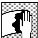
Remover qualquer contaminação da superfície, utilizando M700, Anti Static Degreaser ou M850.
